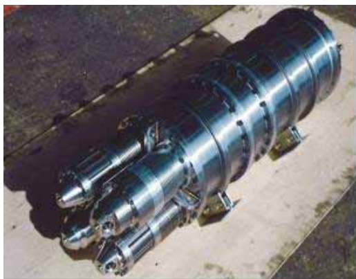
写真１ 左：２クランク式４気筒スターリングエンジン、 右：スチームランキンスターリングエンジン （一色尚次元東京工業大学教授設計・（株）NERC 製）
