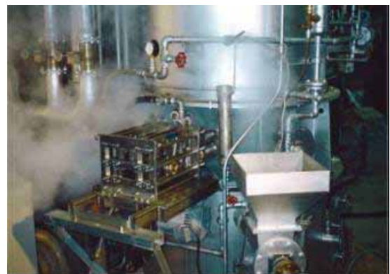
写真１ 左：２クランク式４気筒スターリングエンジン、 右：スチームランキンスターリングエンジン （一色尚次元東京工業大学教授設計・（株）NERC 製）
