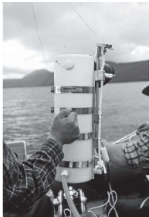
写真-1 バンドーン採水器(シッシー)
