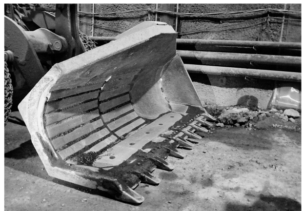
写真-11 札幌トンネル横排土式バケット重機
