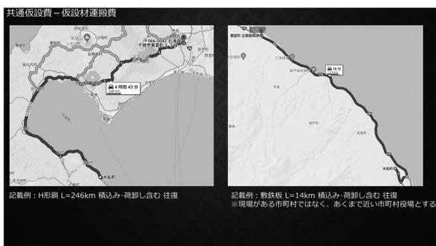
図-1 共通仮設費-仮設材運搬の考え方
