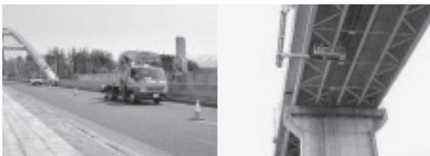
写真-4 橋梁点検車(BT-200)
