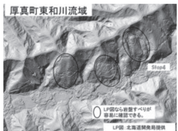
図-12 図-15 付近の LP 図(北海道開発局提供)。○の部分が地すべりを起こしていることが分かる。
