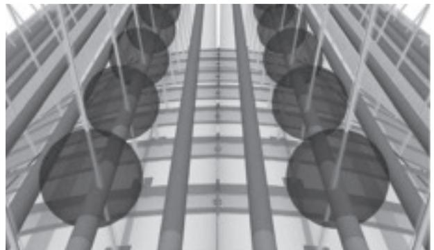
図-3 3D モデルによる AGF 鋼管とロックボルトの干渉確認(BIM / CIM 活用)
