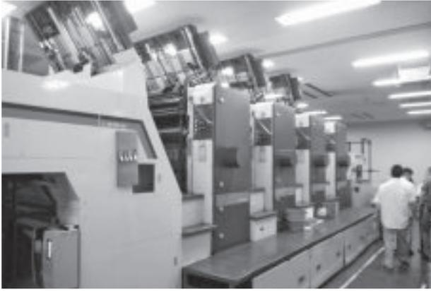
写真-1 A倍判4色オフセット印刷機
