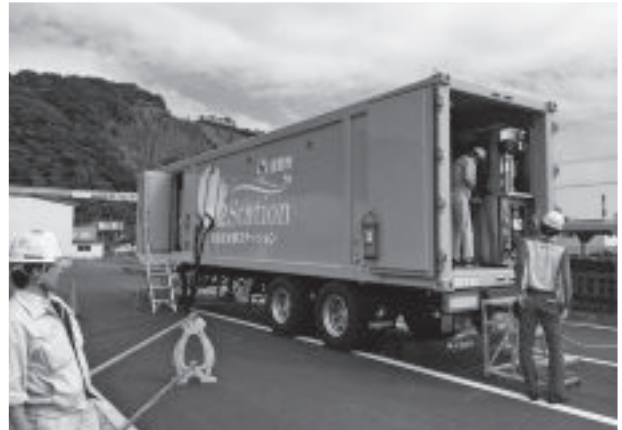
図-5 移動式水素ステーション
