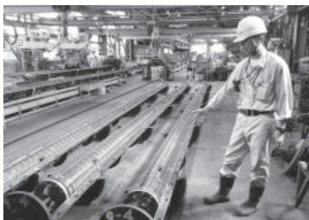
図-3 電柱の製作(コンクリート打設前)
