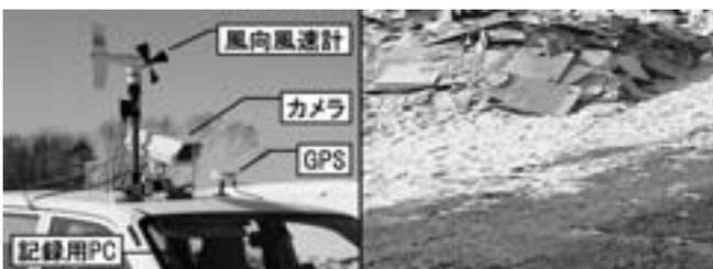
図-6 車載型監視装置と記録映像
