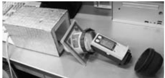
図-8 硫化水素検知装置
