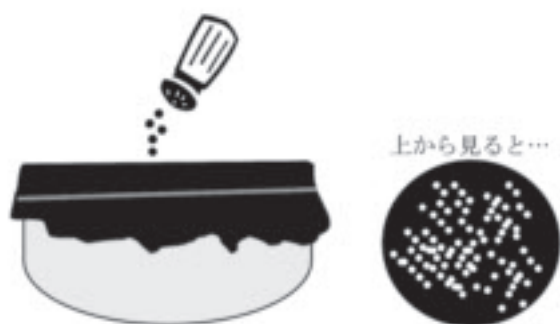
図-3 共振装置の作り方
