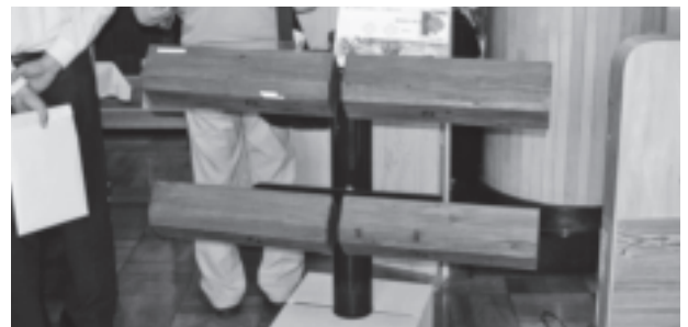
集成材と鉄を組み合わせた次世代型ガードレール
