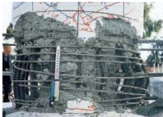
カリフォルニア大学バークレイ校の地震工学研究センターで見かけ た、実験後の鉄筋コンクリート柱。帯鉄筋による拘束効果の実験で あろう。
