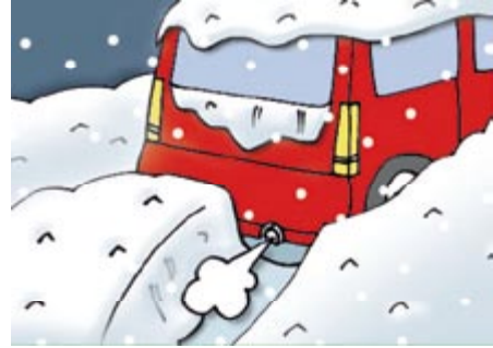
マフラーの除雪をしましょう！ (冬道運転ガイド:寒地土木研究所)
