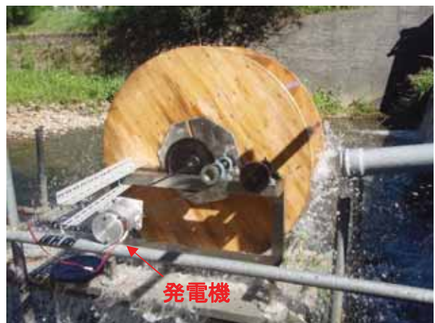
〔仮設発電機によるLED照明の点灯実験〕
