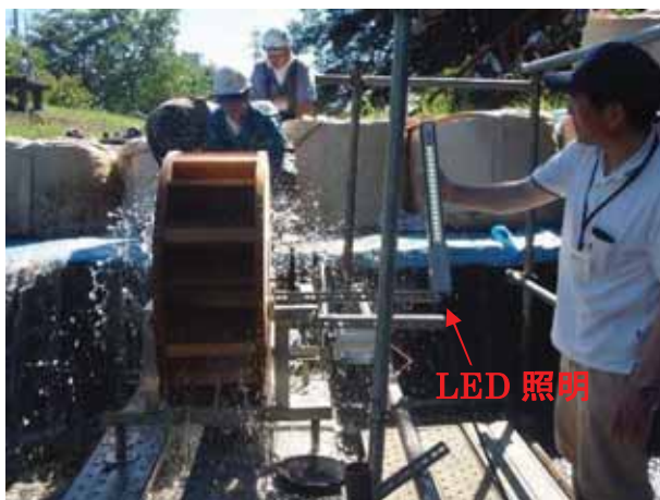
〔仮設発電機によるLED照明の点灯実験〕
