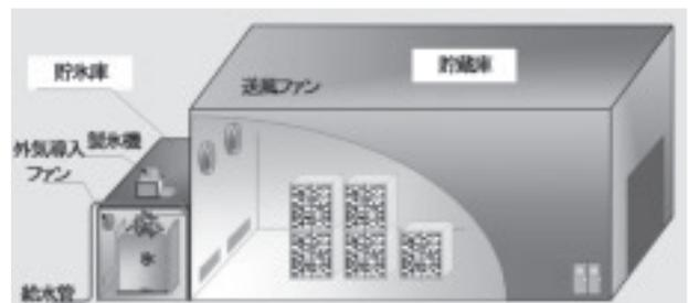
図-2 氷冷熱の倉庫への適用
