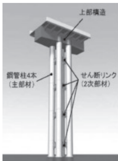
写真-3 鋼管集成橋脚
