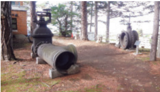
前庭に展示された大口径水道管と仕切弁
