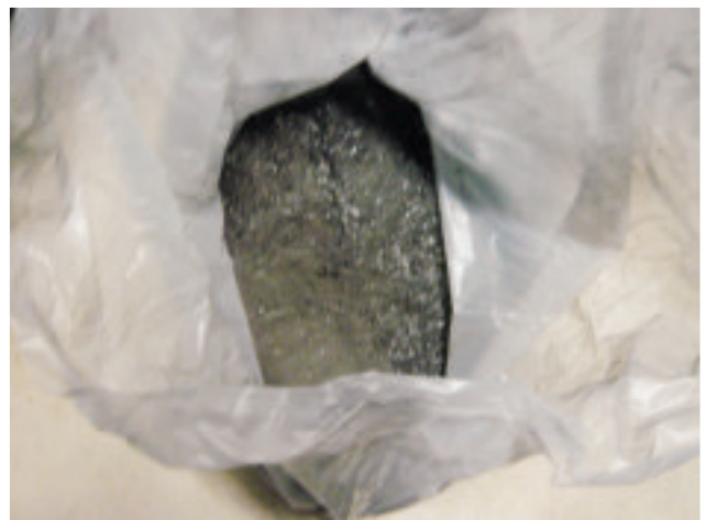
木質バイオマスボイラーから排出される焼却灰 (リサイクルについて検討中)
