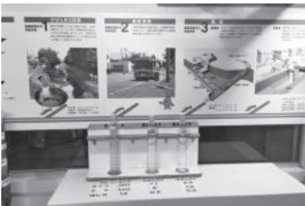
左から 流入水、高級処理水、高度処理水
